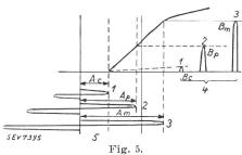
Amplification en régime C. Modulation de 100 % du courant anodique par une modulation de 50 % de la tension de grille. I Creux de modulation. 2 Intensités en porteuse. 3 Intensités en crète. I Courant anodique modulé à 100 %. 5 Excitation de grille, modulée à 50 %.
