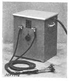
Beschreibung: Apparat gemäss Abbildung für Bördel- und Stumpfschweissung dünner Bleche aus Aluminium und Aluminiumlegierungen. Transformator mit regulierbarer Sekundärspannung (4 bis 8 V). Das Schweissen erfolgt mit Kohleelektroden, die den Blechrändern entlang geführt werden. Der Stromdurchgang bewirkt die nötige Erwärmung der Schweisselektroden.
