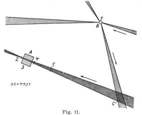
Schematische Darstellung des Zusammenwirkens von Navigations- und Landungsbake. 1 Navigationsbake. 2 Landungsbake. 3 Flugplatz. 4 Hauptsignal. 5 Vorsignal. Distanz zwischen A und B 10 km, zwischen A und C 15 km.
