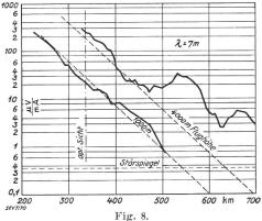
Beispiel für die Berechnung: gerechneter und gemessener Verlauf der Feldstärke. Sender 1000 m über Erde. P=7000 W,  $\lambda=7$  m.
