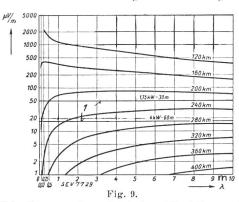
Feldstärke-Kurven entsprechend einer Flughöhe von 1000 m. Höhe des Dipols über dem Boden 30 m. Flughöhe 1000 m. Reichweite der optischen Sicht 124 km. Strahlungsleistung 1,75 kW. 1 Untere Grenze der für den Empfang nötigen Feldstärke.
