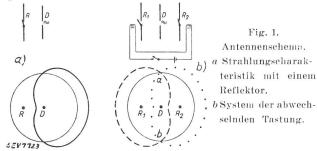
Das Prinzip der Methode wird durch die schematische Fig. 1 erläutert. Stellt man neben einen vertikalen Dipol einen gleich grossen, in der Mitte kurz geschlossenen Dipol als Reflektor, so resultiert im allgemeinen eine herzförmige Strahlungscharakteristik. Benutzt man zwei Reflektoren, die abwechselnd kurz geschlossen und wieder geöffnet werden,
