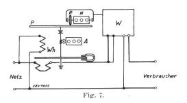
einflusst, dass das Uebersetzungsverhältnis zwischen der Zähleraxe und dem Zählwerk N zu jeder Zeit der Wirkleistung proportional ist. Durch das Zählwerk wird also eine dem Integral N [Formel (4)] proportionale Grösse angezeigt.
