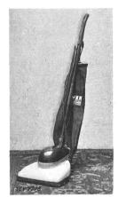
Elektrischer Beschreibung: Staubsauger gemäss Abbildung. Zentrifugalgebläse sowie eine über Saugöffnung angebrachte Walze mit Klopfrippen und Bürsteneinsätzen durch ventilierten Einphasen-Seriemotor angetrieben. Motorwicklung für grössere oder kleinere Leistung umschaltbar. Kleine Glühlampe in das Gehäuse eingebaut.
