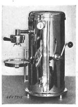
Beschreibung: Elektrische Kaffeemaschine, gemäss Abbildung, mit Heizkörper, der betriebsmässig mit dem Wasser nicht in Berührung steht. Wasserbehälter ohne Wärmeisolation in einem verchromten Blechzylinder eingebaut und mit den nötigen Armaturen für Kaffeezubereitung versehen. Eintauch-Temperaturregler und an der Verschlußschraube der Einfüllöffnung doppelter Schutz gegen Ueberdruck durch Sicherheitsventil und Schmelzsicherung vorhanden.
