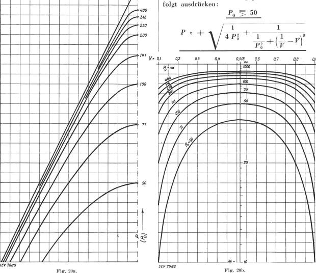
Verlauf von  $\Theta$  zwischen V=0.1 und 0.9 Verlauf von P in der Nähe der Resonanzstelle für praktisch vorkommende  $P_0$ -Werte (sehr guter Rundfunk-Schwingkreis:  $P_0 \approx 200$ ).
