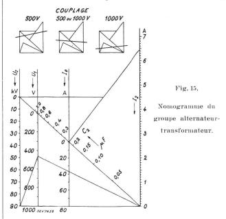
le courant d'excitation de l'alternateur pour le couplage 500 V et la capacité du câble en essai. Il suffit de joindre par une droite le point de l'échelle  $U_2$  avec celui de l'échelle  $I_2$  ou de l'échelle des capacités correspondant au cas envisagé pour obtenir par intersection avec les autres échelles les valeurs correspondantes. Selon la position de cette droite, on devra choisir l'un ou l'autre couplage, comme l'indiquent les petits diagrammes.
