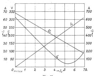
Fig. 13. Essai du groupe alternateur-transformateur  $U_2=30$  kV;  $\cos\varphi_2=0$  avance.
