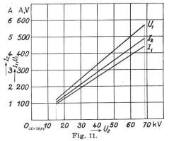
Courant maximum au secondaire du transformateur  $I_2=f$  ( $U_2$ ) pour  $U_2$  compris entre 15 et 68,5 kV  $I_0=0$  cos  $\varphi_2=0$  avance.
