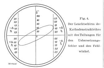
reichend grosse Kapazität geschaltet, so ändert sich dadurch der Winkel zwischen dem Differenzstrome und dem magnetisch aktiven Teile des Sekundärstromes des Normalwandlers in einer bestimmten, durch den Fehlwinkel des Normalwandlers gegebenen Weise. Wird nun in derselben Weise in der Schaltung nach Fig. 1 verfahren, so kann man dadurch das Vorzeichen des Fehlwinkels des Prüflings bestimmen. Dasselbe gilt sinngemäss für die Blinkschaltung.
