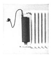
Beschreibung: Heiztransformator (Semo-Trafo) für Anbau an Zentralheizungs-Radiatoren. Der Wasserinhalt wird durch die auf einem Durchflussrohr angeordnete Sekundärwicklung des Transformators erwärmt und in Zirkulation gebracht. Solche Heiztransformatoren können an Zentralheizungs-Radiatoren mit einer Oberfläche von mindestens 3 m², als Zusatzheizung für die Uebergangszeiten, angebracht werden.
