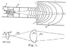
En haut: Canon électronique. 1 Grille de commande. 2 Première anode. 3 Cathode. 4 Seconde anode. En bas: Equivalent optique approximatif. Indices de réfraction:  $\mu_1 > \mu_2 > \mu_3 > \mu_4 > \mu_5$ .
