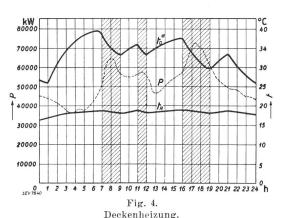
Temperaturverlauf bei den schraffierten Sperrzeiten:  $t_{\rm D}$  an den Deckenoberflächen und  $t_{\rm R}$  im Raum. P Wintertagbelastungsdiagramm des EW Zürich.
