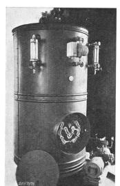
Fig. 2. Akkumulierdampfkessel.
