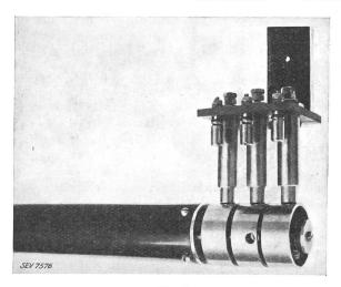
Fig. 3. Walzenheizung, 4 kW, zum Einschieben in Trockenzylinder.
