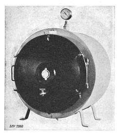
Fig. 7. Laboratoriums-Vakuumschrank.
