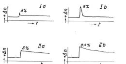
Verlauf der Drehzahl bei plötzlicher Entlastung der Turbine.
