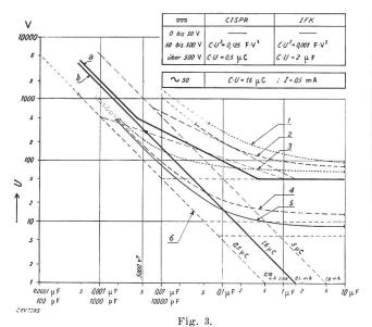
Grenze der Berührungsspannung in Funktion der Kondensatorgrösse,
