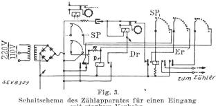
Schaltschema des Zählapparates für einen Eingang mit starkem Verkehr.  $\begin{array}{cc} Dr \ Er & \text{Relais} \\ SP_1 & \text{Anruf sucher.} \end{array}$
