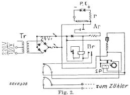
Schaltschema des Zählapparates für einen Eingang mit schwachem Verkehr. Ar Galvanometer-Relais Br Telephon-Relais.
