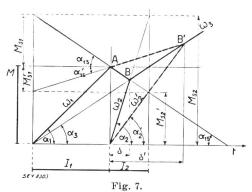
Stoss zweier verschieden grosser Massen  $I_1 > I_2$  (auf dieselbe Drehzahl bezogen) M Motordrehmoment A Beginn des Stosses B-B' Ende des Stosses
