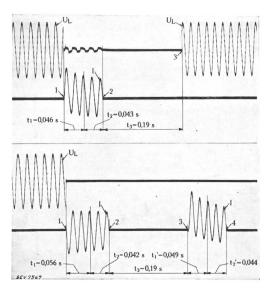
Fig. 40. Oszillogramm des Aus- und Wiedereinschaltens mit dem 150-kV-Druckluftschnellschalter.
