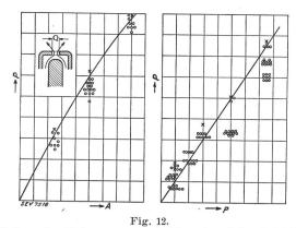
Einfluss des Strömungsquerschnittes  ${\cal A}$  und des Betriebsdruckes p auf die Abschaltfähigkeit  ${\cal P}$  von hohlen Kontakten.
