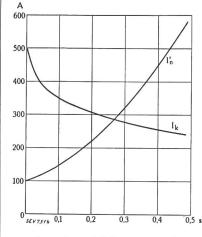
Fig. 8. Synchronisierungsstromstoss  $I'_{\mathfrak{o}}$  nach verschiedener Kurzschlussdauer im Vergleich zum Abklingen des Kurzschlussstromes Ik.
