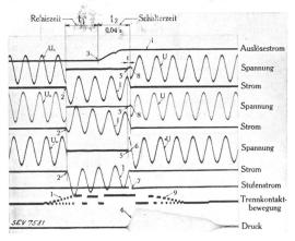
Fig. 24. Oszillogramm der Ein-Aus-Schaltung mit dem 750-MVA-Druckluftschnellschalter.
