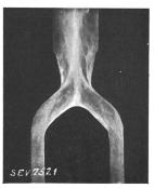
Fig. 14. Strömungsbilder bei grosser und kleiner Unterbrechungsdistanz der Kontakte.
