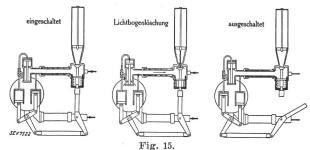
Grundprinzip des Druckluftschnellschalters.
