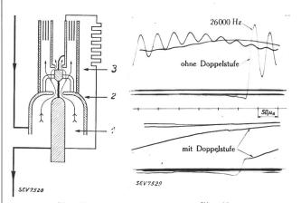
Fig. 21. Doppelstufige Lichtbogen-löschung mit hohlen Kontakten. Luftzufuhr, 2 Löschkon-takt, 3 Funkenstrecke.
