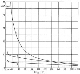
Eigenfrequenzen von Transformatoren und Kraftwerken mit Einheitsleistungen von 20 MVA bei verschiedenen Betriebsspannungen.
