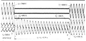
Fig. 7. Strom- und Spannungsschwankungen des Generators bei kleiner und grosser Kurzschlussdauer.
