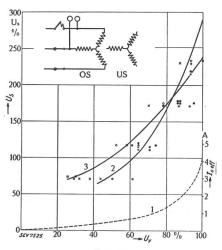
Fig. 18. Maximale Schaltspannungen beim Ausschalten eines 5000-kVA-Transformators.
