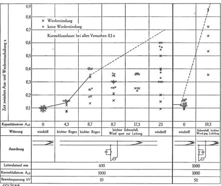
Fig. 37. Verschlechterung der Entionisierung von Kurzschlusslichtbogen durch kapazitive Restströme.
