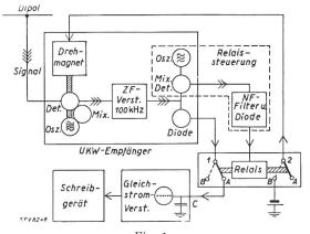
Fig. 1. UKW-Breitband-Feldstärkemessgerät, Blockschema. (Relais in Arbeitsstellung.)
