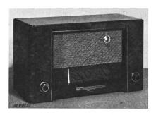
Beschreibung: Kombinierter Radio- und Telephonrundspruchapparat gemäss Abbildung. Apparat für den Empfang kurzer, mittlerer und langer Wellen, ferner für Telephonrundspruch und Grammophonverstärkung. Lautstärkeregler, Tonblende und Programmwähltaste. Anschluss eines zweiten Lautsprechers möglich.
