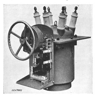
Fig. 3. Oelschalter 12 kV, 150 MVA, offene Unterbrechung, mit direkt angebautem Federspeicherantrieb.
