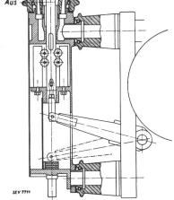
Fig. 14. Druckluftschalter mit keramischer Isolation für feuchte Räume, Der Schalter besitzt Doppeldüse.
