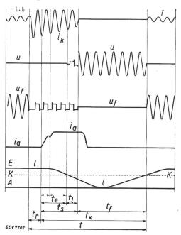
Fig. 1. Zeitbegriffe bei Schaltern für automatische, unverzögerte Wiedereinschaltung.
