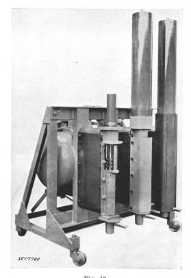
Fig. 13. Druckluftschalter, 27 kV, 500 MVA.
