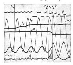
Fig. 6. Abschaltoszillogramm an Oelschalter Typ E 88. 1 Beginn der Auslösung. 2 Oeffnung der Kontakte. 3 Ende der Abschaltung.
