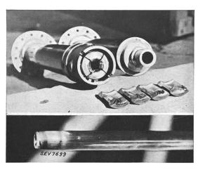
Fig. 11. Kontakte eines ölarmen Gegenstrom-Schalters, 135 kV, nach einer Reihe von Kurzschlussabschaltungen.
