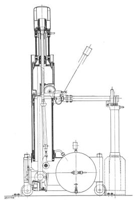
Fig. 19. Schnitt durch Druckluftschafter Typ LS, 64 kV.
