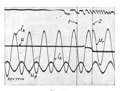
Fig. 10. Oszillogramm einer einpoligen Abschaltung mit ölarmem Gegenstromschalter, 150 kV.
