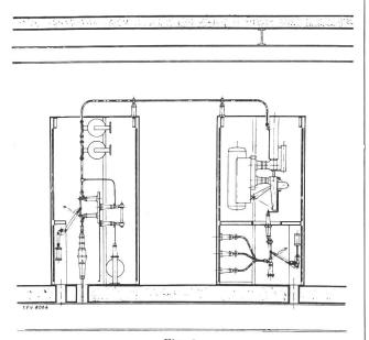
Fig. 3. Schaltanlage 20 kV mit Sammelschiene unten, in bestehenden Raum eingebaut.
