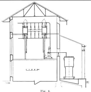
Querschnitt einer 60-kV-Schaltanlage mit Oelstrahlschalter. Umbau einer bestehenden Anlage.
