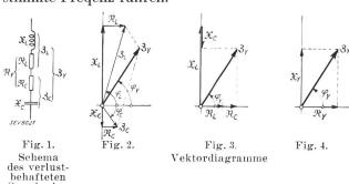
Die Gleichung für die Serieschaltung (Index Y) der Spulen- und Kondensatoren-Impedanzen lautet:
