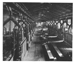
Fig. 6. Elektrolysierraum in Chippis.
