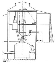
Fig. 3 (oben). Elektrischer Niederschachtofen, schematischer Schnitt.
