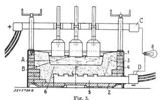
Zelle für Aluminium-Elektrolyse für 8000 A.
