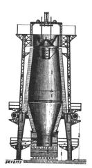
Fig. 1. Kokshochofen, schematischer Schnitt.
