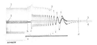
$\begin{array}{c} {\rm Fig.~9.} \\ {\rm Oszillogramm~der~Bremsung~eines~440\text{-}kW\text{-}Synchromotors~zum} \\ {\rm Antrieb~einer~Gummi\text{-}Walzenstrasse.} \\ {\rm ZeitmaBstab:~50~Hz} = 1~{\rm Sekunde,} \\ {\rm 5~Hz} = 1~{\rm Umdrehung.} \\ \end{array}$
