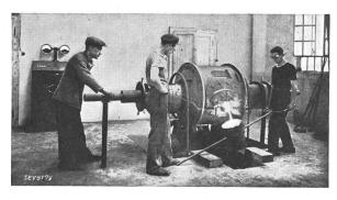
Fig. 1. Einphasen-Lichtbogen-Trommelofen für Grauguss u. Stahlguss. Charge ca. 150 kg, Anschlusswert ca. 100 kW
