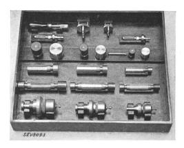
Fig. 9. Beispiel eines Lehrensatzes für Sicherungselemente und Schraubköpfe.
