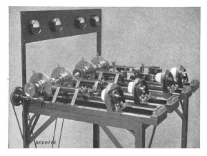
Fig. 6. Prüfmaschinen für Steckkontakte und Druckknopfschalter, Verhalten im Gebrauch.
