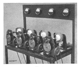
Fig. 7. Prüfmaschinen für Drehschalter, Verhalten im Gebrauch.
