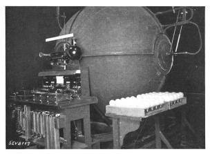
Fig. 11. Kugelphotometer zur Ermittlung des Lichtstromes elektr. Lampen, Doppeleinrichtung für subjektive und objektive Messung.
