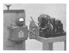
Fig. 8. Prüfmaschine für Hebel-Kastenschalter, Verhalten im Gebrauch.
