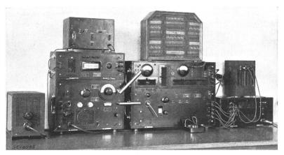
Fig. 12. Messplatz zur Ermittlung von Radiostörungen elektrischer Apparate.
