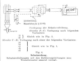
Transformator mit den Niederspannungsleitungen in ein gemeinsames Rohr eingezogen oder im gleichen Kabel mitgeführt werden. Seine Isolation muss gleich derjenigen der im gemeinsamen Rohr verlegten Polleiter sein; ausserdem muss er den gleichen Querschnitt wie die Polleiter, mindestens aber 2,5 mm² aufweisen. Wird diese Nullungs- oder
