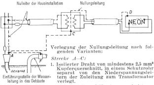
Blanker Draht von mindestens 6 mm² Kupferquerschnitt, se-parat von den Niederspannungsleitern der Zuleitung zum Transformator in Rohr verlegt oder auf Porzellanrollen befestigt.
