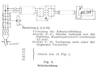
Schutzerdleitungen mit den Zuführungsleitungen zum Transformator im gleichen Rohr verlegt.
