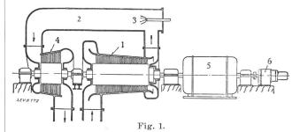
Schema einer Gasturbinenanlage. 1 Luftverdichter. 2 Brennkammer. 3 Oelflamme. 4 Turbine. 5 Generator. 6 Anlassmotor.
