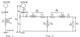
Kopplungs-kondensator C<sub>1</sub> mit in Serie geschaltetem Messwandler. Fig. 2.
