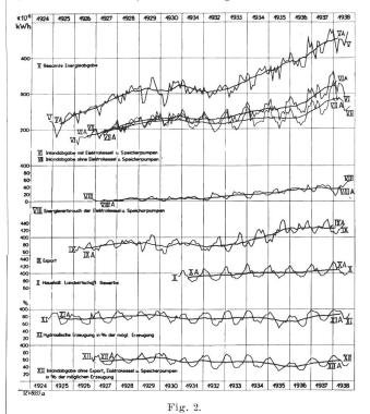
Energieverwendung und Ausnutzungsgrad der schweizerischen Elektrizitätswerke von 1924 bis 1938.
