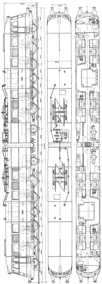
Fig. 1. Generelle Anordnung der Lokomotive.
