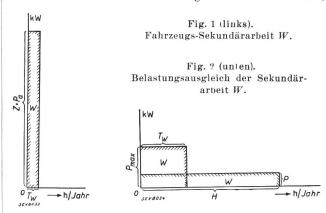
dessen eine Seite  $T_a$  unten an der Zeitaxe und dessen andere Seite  $Z \cdot P_a$  links an einer Effektaxe liegen. Diese Figur genügt gleichzeitig dem Fall thermoelektrischer und jenem rein elektrischer Fahrzeuge. Im zweiten Fall kann jedoch für W auch die durch den Belastungsausgleich beeinflusste Darstellungsart im elektrischen Kraftwerk gegeben werden. In Fig. 2 ist W demgemäss durch zwei Rechteckbilder gegeben worden, die durch die Gleichung:
