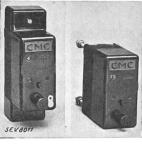
Beschreibung: Einpolige Sockel - Installationsselbstschalter gemäss Abbildungen, mit thermischer und elektromagnetischer Ueberstromauslösung. Druckknopfbetätigung. Die Nullleiter - Abtrennvorrichtung ist mit dem Einschaltdruckknopf verriegelt. Sockel aus keramischem Material,
