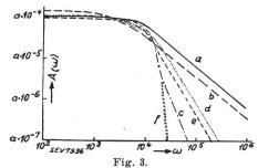
Amplitudenspektren, bzw. deren Umhüllende für die in Fig. 2 dargestellten Impulse.  $A(\omega)$  Teiltonamplitude.  $\omega$  Kreisfrequenz.
