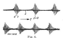
Oszillogramme eines in niederfrequentem Takte tröpfelnden 1000-Hertz-Generators.
