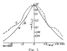
Impulsspektren eines zweistufigen, in der Steuerstufe getasteten Senders.
