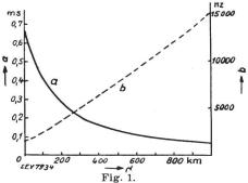
Laufzeitdifferenz zwischen Bodenimpuls und erstem Echo (a) sowie notwendige obere Grenzfrequenz der Uebertragung (b) in Abhängigkeit von der Peilentfernung (d).
