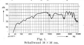
Schallwand von 56 cm Seitenlänge, Fig. 2 für eine rechteckige mit Seitenlängen von 110 und 90 cm; das Lautsprechersystem war bei beiden zentral angeordnet. Die grössere Schallwand bringt eine Verbesserung der Wiedergabe bei 100 Hz um 4 db; es resultiert schon ein als gut zu qualifizierender Frequenzgang. Diese Verhältnisse ändern sich aber gründlich, wenn der Lautsprecher nach rückwärts
