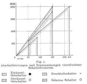
spannungen und kleine Stationen stellt der Oelschalter immer noch die zweckmässigste Lösung dar, in der Regel als Einkesselschalter, verwendbar im Freien, wie in geschlossenen oder sogar in feuchten Räumen, Fig. 1. Darauf folgt der Druckluftschal-
