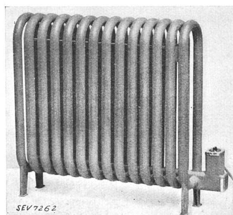
Beschreibung: Elektrischer Heizradiator gemäss Abbildung. Heizelement im unteren Querrohr eingebaut. Radiator mit Öl gefüllt. Eingebauter Schalter ermöglicht, den Radiator mit 1/3, 2/3 und 3/3 der Heizleistung zu betreiben.
