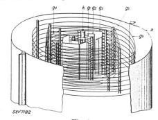
Fig. 1. Zeichnerische Darstellung der Konstruktion der Vierbündeloktode.
