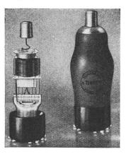
Fig. 3. Die rauscharme Hochfrequenz-Regelpenthode EF S.
