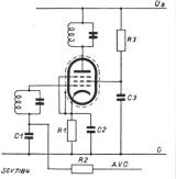
Fig. 7. Gleitende Schirmgitter-spannung bei der EF 9.
