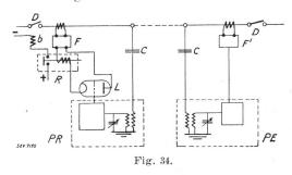
En service normal, le courant ne contient que la composante directe de fréquence f, que les filtres refoulent; la lampe n'est pas alimentée, même si les courants sont différents aux deux extrémités. En cas de défaut, les alternances des composantes inverses et homopolaires aux deux extrémités sont évidemment en phase pour défaut extérieur au tronçon (verrouillent la lampe) et en opposition de phase pour défaut interne (le courant s'établit).
