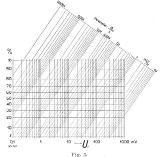
Prozentsatz der Anwohner-Empfangsanlagen, welche durch die Fahrdrahtstörspannung  $U_{\rm F}$  unzulässig gestört werden.
