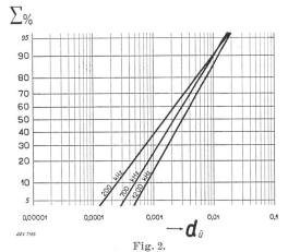
Prozentsummenkurven für das Verhältnis der Störspannung in Anwohner-Antennen zur Störspannung am Fahrdraht.
