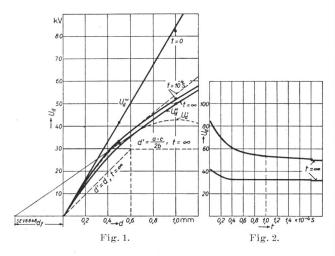
fort; die Nachgiebigkeit des Stoffes dürfte auch zu einer Verbreiterung der Berührungsstellen beigetragen haben. Daher sei das Messergebnis an Hartgummi hier herangezogen. In Fig. 1 ist zunächst eine Gerade aus dem Ursprung gezogen, die den Messwerten der Durchschlagspannung bei  $t=10^{-8}\,\mathrm{s}$  entspricht. Sie wird mit der Durchschlagsfunktion
