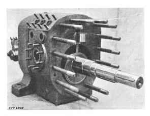
Fig. 13. Rotationskompressor, geöffnet.
