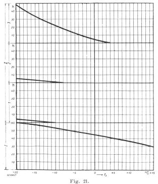
Heizprogramm für Innentemperatur von 18° C, bei verschiedenen Aussentemperaturen  $t_3$ .
