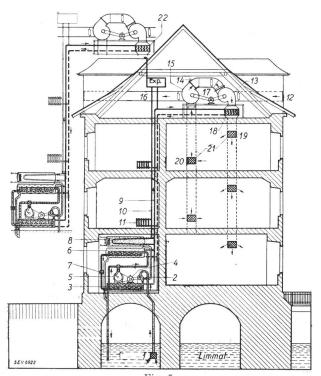
Fig. 7. Schema der Anlage im Zürcher Rathaus. Heizbetrieb:
