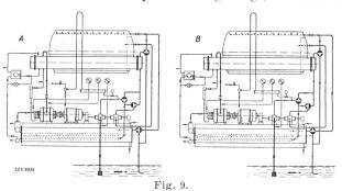
$\begin{array}{c} {\rm Betriebs schema.} \\ {\rm \textit{A} \ Winterbetrieb} \end{array} \text{ (Heizen). } {\rm \textit{B} \ Sommerbetrieb} \text{ (K\"{\it u}hlen).} \\ \end{array}$
