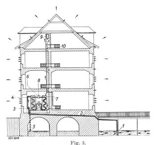
Prinzip der Wärmepumpenheizung.
