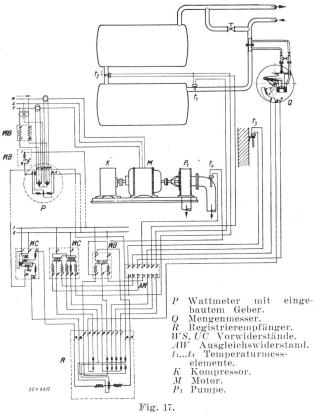
Registrierende Wärmebilanz-Messeinrichtung (Messung von Temperatur, Leistung und Wassermenge).
