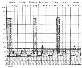
Der Leistungsbedarf für die Heizung des Zürcher Rathauses im Verlauf einer Woche. Vorausgesetzte Aussentemperatur  $-20^{\circ}$  C.
