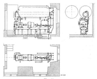
$\label{eq:Fig. 10.} {\it Fig. 10.}$  Wärmepumpenaggregat mit Ausgleichsgefäss.
