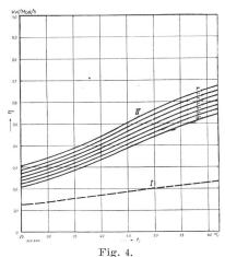
Spezifische Antriebsleistung  $(\eta)$  der Wärmepumpe in kW/1000 keal/h in Funktion der Vorlauftemperatur  $(t_2)$  der Zentralheizung in °C.
