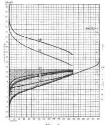
Fig. 5. Häufigkeitskurven auf Grund 60jähriger Erhebungen in Zürich. Kurve der mittleren Tagestemperatur in °C. Beispiel An 200 Tagen liegt die mittlere Tagestemperatur unter 10° C, bzw. an 165 Tagen über 10° C. Kurve der Temperatur des Limmatwassers in °C. Einzuhaltende Raumtemperatur in °C. Kurve der Vorlauftemperatur des Zentralheizungswassers in °C.
