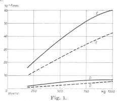
Elastische (E) und dauernde (D) Zusammendrückbarkeit von «Transformerboard», 3 mm dick, unter einem flachen, kreisrunden Stempel von 1 cm² Fläche, gemessen in Luft bei 20°, nach vorherigem Auskochen des Materials in Oel von 105° während 72 h. Dauer der Belastung: 1 min.
