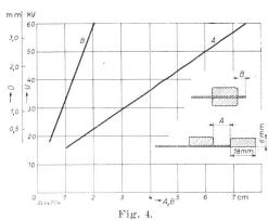
Abstände A und B, bei welchen zwischen zwei Elektroden (18 mm  $\times$  45 mm) bei zunehmender Durchschlagsspannung die ersten Gleitfunken über das ölgekochte «Transformerboard» auftreten. Die Prüfung wurde unter Oel mit einer Spannungssteigerung von 200 V/s durchgeführt. Die einer bestimmten Durchschlagsfestigkeit entsprechenden Materialdieken D sind neben der Ordinate aufgetragen.
