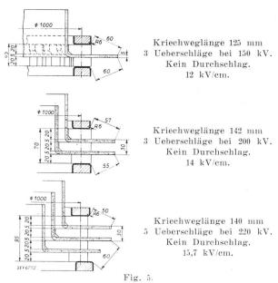
Versuche an Enddistanzringen aus «Transformerboard».
