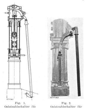
seine bewährten Oelstrahlschalter für Freiluft, auch einen besonderen Innenraum-Typ nach dem Oelstrahlprinzip entwickelt, der bestimmt ist, den klassischen Oelschalter in allen jenen Fällen zu ersetzen, in denen eine Druckluftanlage aus den erwähnten Gründen nicht in Frage kommt.
