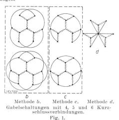
Die verschiedenen Kurzschlussmöglichkeiten bei sechsphasiger Gabelschaltung im Vergleich mit dem Kurzschluss bei Sternschaltung.
