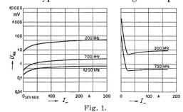
Typische Störkennlinien. Störspannung in mV in Funktion der Gleichstrombelastung in A von zwei verschiedenen Gleichrichteranlagen.
