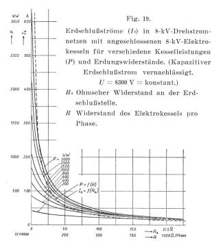
lassen werden. Sobald nämlich eine Phase des Netzes Erdschluss hat, steigen die Kesselströme in den übrigen zwei Phasen, so dass die Maximalstromrelais den Schalter zum Auslösen bringen. Solche Elektrokessel findet man in der Praxis allerdings
