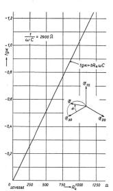
Fig. 6. Direkter Erdschluss über ohmschen Widerstand. Bestimmung des Winkels a.
