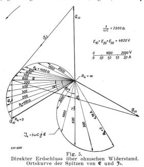
dieses Vektors ist gleichbedeutend mit dem Erdpunkt. Das aufgezeichnete Diagramm gilt für ein 8-kV-Netz mit 5 A «Erdschlußstrom» ( $\frac{1}{\omega C}$  = 2900 Ohm). Will man für einen bestimmten Erdungswiderstand & einzeichnen, so trägt man am einfach-
