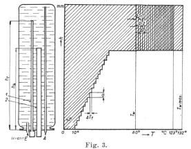
Temperaturverlauf bei Annäherungsrechnung und Temperaturschichtung in der Heisswasserzone bei algebraischer Bestimmung.
