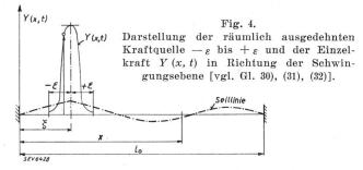
Kraft Y(x, t), die sich auf die in t periodische Funktion  $\sigma_s f(x) \cdot \cos \omega_0 t$  reduzieren lässt, wird nach Gl. (37) die Koordinate y eines jeden Seilpunktes für y = 1 (Grundharmonische)
