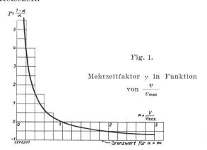
Ein Beispiel: Eine Strecke mit 50 statt 100 km/h (a=0.5) befahren, gibt Mehrzeitfaktor 1. Dieselbe Strecke mit 16,7 statt 20 km/h befahren, gibt auf  $v_m=100$  km/h bezogen denselben Faktor 5-4=1, also dieselbe Mehrzeit. Dieselbe Strecke
