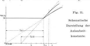
Generator-Aggregates in dieser Hinsicht durch die Grösse der sogenannten Anlaufzeitkonstante, das ist die Zeit, welche nötig ist, die Gruppe mit normalem Drehmoment vom Stillstand auf die normale Drehzahl zu beschleunigen und welche gegeben ist durch
