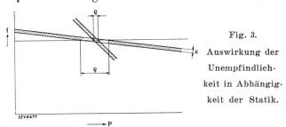
bei kleinen Werten. Im Grenzfall, d. h. bei astatischer Frequenzregulierung (z. B. mit Isodrom-Reglern) ist die Lastverteilung labil. Es scheint darum naheliegend, bei Frequenzhaltung, wo mehrere Maschinen oder Werke parallel arbeiten, mit höheren Statikwerten die sichere Lastverteilung zu erzwingen und mit Zusatzeinrichtungen dafür zu sorgen, dass die durch die höhere Statik bedingte Frequenzabweichung kompensiert wird.
