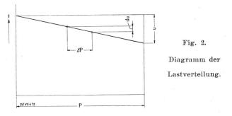
Fig. 2 seien diese Verhältnisse kurz erläutert. P stellt die gesamte Netzleistung dar,  $\Delta P$  die vom frequenzhaltenden Werk lieferbare Energie.
