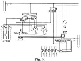
Schema der Leistungs-Programmsteuerung.
