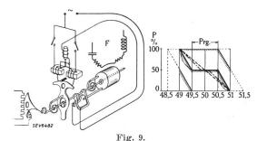
Leistungs-Sollwert-Steuerapparat mit Frequenzüberwachung.
