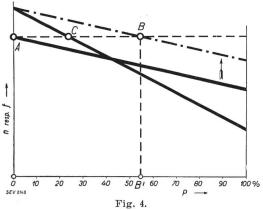
Lastaufnahme nach dem Parallelschalten.
