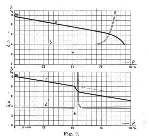
Drehzahlcharakteristiken und Ungleichförmigkeitsgrade,
