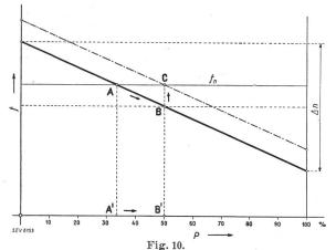
Laständerung durch «Drehzahlverstellung».
