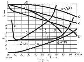
Drehzahlcharakteristiken und Ungleichförmigkeitsgrade.
