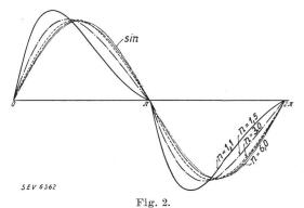
Verlauf des erzugten Wechselstromes.
