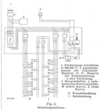
ebenfalls aus dem Einheitsnetz über einen Einphasentransformator 380/75 V gespeist. Diese Lampen dienen gleichzeitig als Notbeleuchtung.
