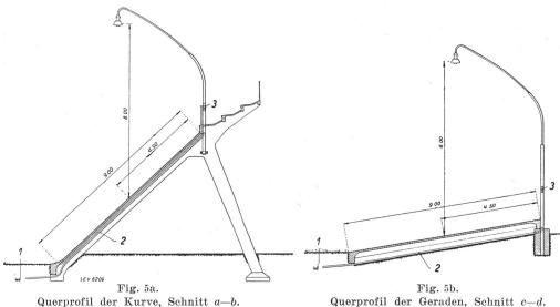
1 Speiseleitung. 2 Zuleitung in Gasrohr. 3 Sicherungs-Kasten.
