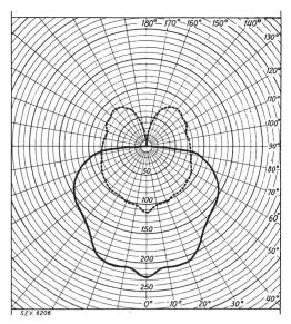
matur beträgt 82  $^{0}$ / $_{0}$ . Fig. 3 zeigt die aus dieser Lichtverteilungskurve berechneten Beleuchtungswerte bei einer Brennpunkthöhe von 8 m über der Messebene.
