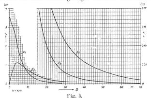
Beleuchtungskurven des LAG-Breitstrahlers Typ SBI 45, bezogen auf einen erzeugten Lichtstrom von 1000 Lumen.
