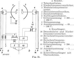
Schema einer Dezimeterwellenverbindung.
