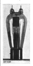
Fig. 14. Senderöhre für ultrakurze Wellen.
