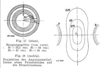
Spiegelrand in der Brennpunktebene liegt. Fig. 18 zeigt die Projektion der Aequipotentiallinien des Paraboloids auf die Directrix-Ebene. Diese Figur und deren Auslegung wurden zum ersten Mal von Darbord in der «Onde Electrique», Bd. 11 (1933), S. 53, veröffentlicht. Dieser Auslegung zufolge trägt jedes Element auf dem Paraboloid, welches auf einer mit 0,5 bezeichneten Projektionslinie gelegen
